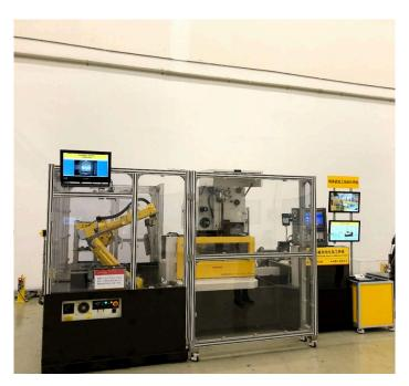
FANUC ROBODRILL DDRIB 是日本发那科慢走丝设备的其中一种型号,这款发那科慢走丝设备具有高速、高精度的附加一轴转台DDRIB可以使用同步内装伺服电机和AICZ传感器,实现无反向间隙的高速、高精度加工。另外,使用DDRIB组成的高刚性摇篮式工作单元能够简便的构成可充分利用ROBODRILL加工区域的分度夹具。
